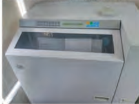
Resim-113: IBM 6262 Model 022 Anaçatı Bilgisayarları için Nokta Vuruşlu Siyah-Beyaz Tek Renkli Yazıcı (Printer - Monochrome – Dot-Matrix)
