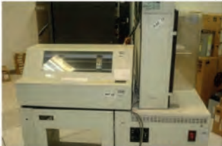
Resim-112: IBM 4245 20 Model Anaçatı Bilgisayarları için Nokta Vuruşlu Tek Renkli (Monochrome – Siyah Beyaz) Yazıcı - Ön Yüzü
